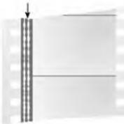
Рис.1. Оптический саундтрек на 35 мм кинолентке
